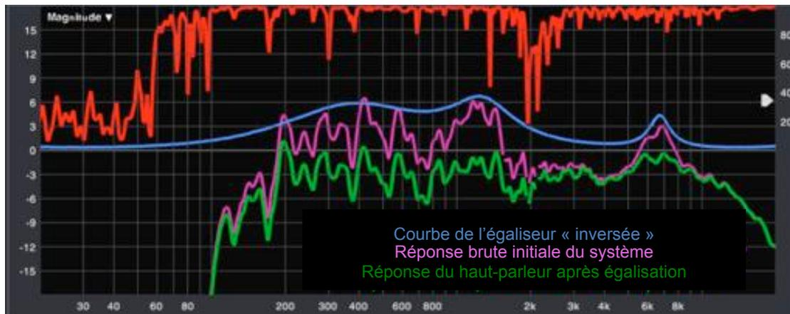
**Figure 35: Mesure des fonctions de transferts**
