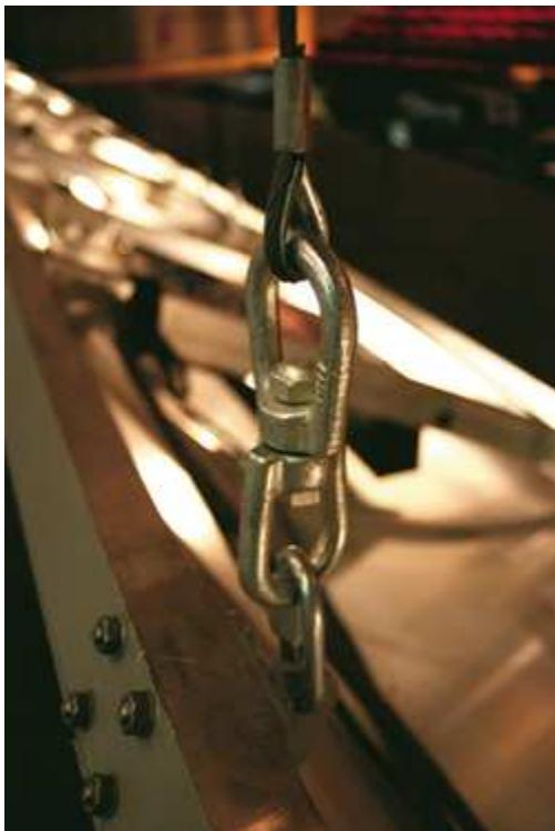
Ce type d'émerillon est utilisé pour le positionnement de la charge au moment de son levage
