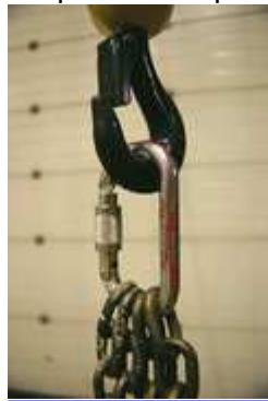
La CMU variant selon la géométrie d'utilisation du mousqueton, le [machiniste](#) se doit de consulter les préconisations délivrées par les fabricants avant de réaliser l'accroche.
