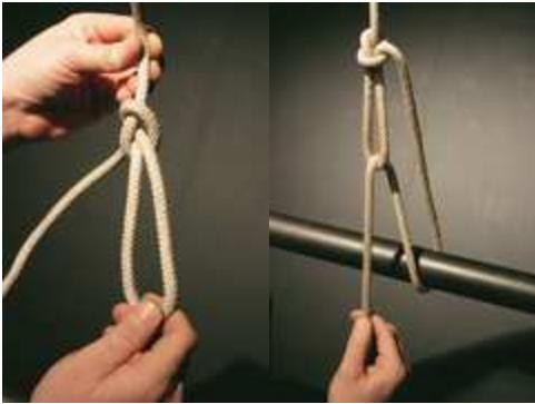
**Le Prussik** : nœud autobloquant empêchant le glissement d'un tube. On peut également réaliser une poignée de tirage en équipant ce nœud sur un cordage.
